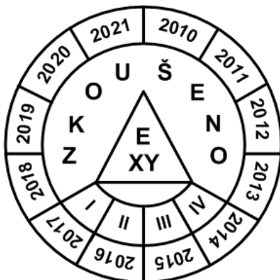
Obrázek 1 - Samolepící značka pro označení roku a čtvrtletí provedení periodické zkoušky (XY - evidenční číslo zkušebny)
